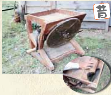
昔 わら切り機 (昭和25年頃まで) 稲わらを均等に切断する手押し式の機械。
