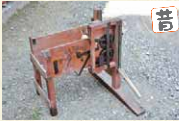
昔 なわない機 (昭和25年頃まで) 稲わらを寄り合わせて縄をつくる機械。差し込み口に藁を差し込みながらペダルを踏み、機械を回転させる。
